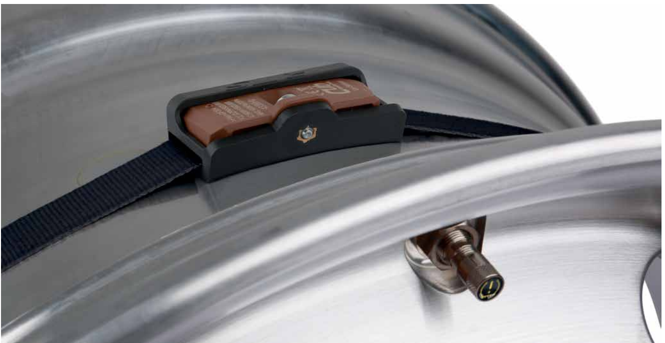
Bild 2: Im Rad liegt der Sensor rutschsicher auf dem Felgenbett in einem Halter aus glasfaserverstärktem Kunststoff. Besonders bei der Montage und Demontage ist er so geschützt vor ungewollten Beschädigungen.
